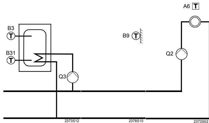
Тип оборудования №12 Регулирование насосной отопительной зоны.
