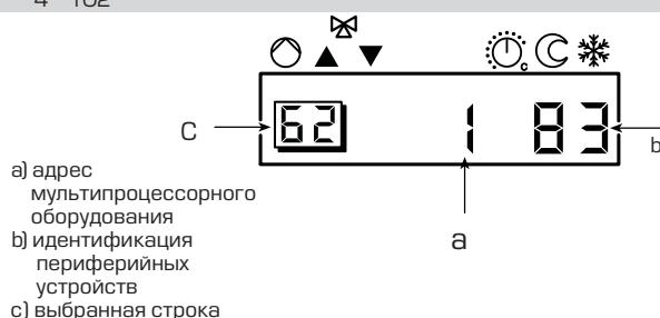
Блок RVA46.531 контура 1 соединен с бойлерной платой котла, которая соответствует № 02 и с комнатным устройством QAA70, которое соответствует № 83.
